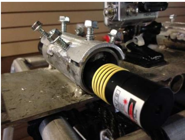
Figure 13: Tube en métal sur un BRUVS permettant le maintien et le calibrage d'un laser. Crédit photo: Nicolas Boudin.
