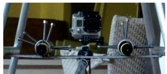
Figure 9: Photogrammetrie laser: une caméra entre deux lasers. Crédit photo: Nicolas Boudin.
