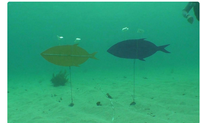
Figure 19. Exemple de silhouettes de poisson (ici poissons de 1 m situés à une distance de 2 m de la caméra) servant à la calibration © Ifremer
