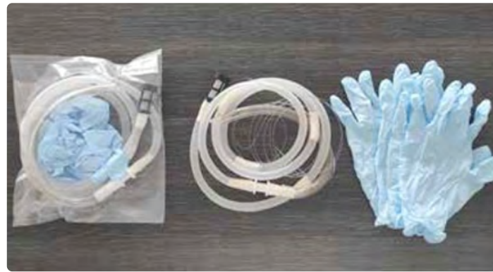
Figure 39. Capsule de filtration, bouchons et tampon de conservation (gauche) et tuyau muni d'une crépine et paire de gants. Images extraites du rapport Giraud et al. (2024) © SPYGEN
