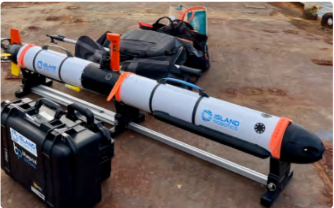
Figure 27. Robot sous-marin de type AUV en forme de torpille © Island Robotics
